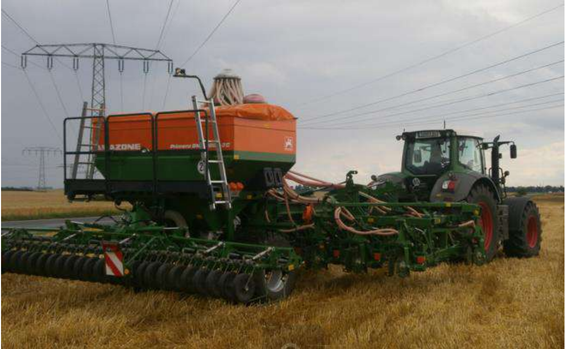
Рис.3. Сеялка DMC Primera шириной захвата от 3 до 12 м
