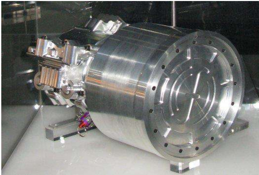
Рис. 3. Маховиковая система KERS.
