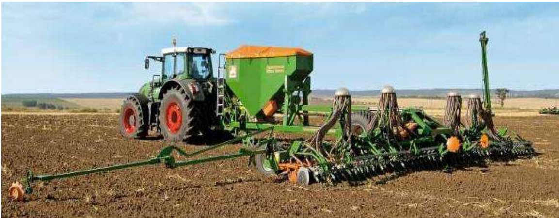
Рис.2. Сеялка Citan шириной захвата от 9 до 15 м
